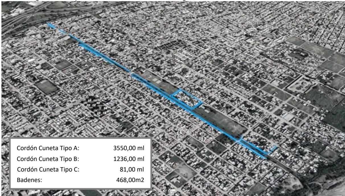
Figura 2.3. Propuesta de Intervención de los Desagües Pluviales
