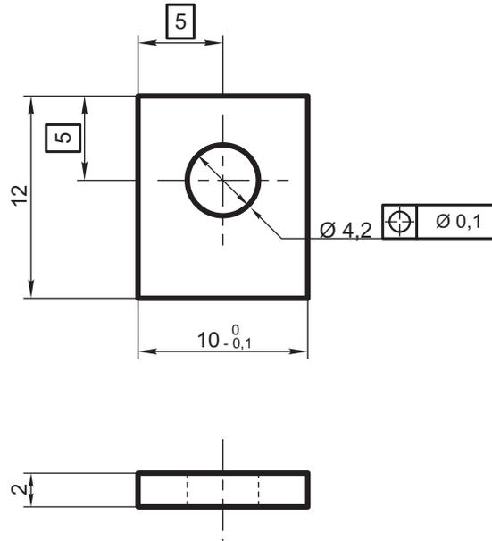
Componente para armado de pieza (4) para fijación cursor
