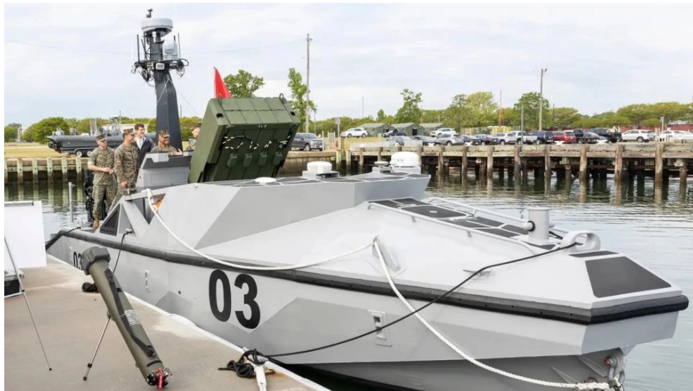
Un vehículo de superficie no tripulado de largo alcance (por sus siglas en inglés, LRUSV) equipado con una plataforma de lanzamiento para disparar municiones merodeadoras Hero-120. Fotografía provista por la Infantería de Marina de Estados Unidos.
