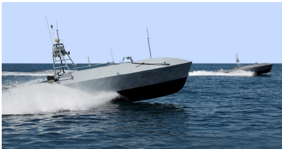
Dos vehículos genéricos de superficie no tripulados (por sus siglas en inglés, CUSV). Fotografía de Textron.
