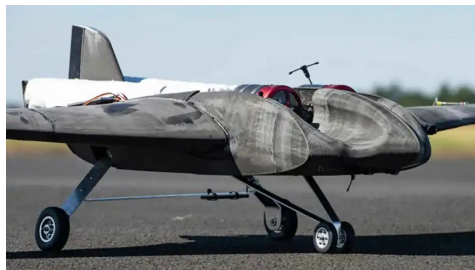
La imagen compartida por la empresa QinetiQ del posible dron impreso en 3D. Fuente: QinetiQ/Fuente: Real Marina Británica.
