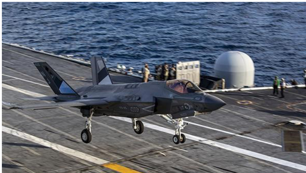
Imagen del F-35C con revestimiento espejado de baja detección en los estabilizadores verticales que aterrizó en el USS Abraham Lincoln el 30 de noviembre
