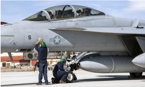
Los sensores de búsqueda y seguimiento por infrarrojos, como este sistema de motores en góndola en un Boeing F/A-18D Super Hornet, pueden identificar incluso aeronaves de sigilo al fijar su objetivo en la firma térmica distintiva de la aeronave
