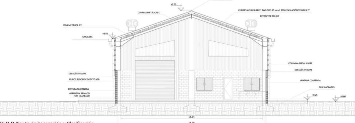
CORTE D-D Planta de Separación y Clasificación
