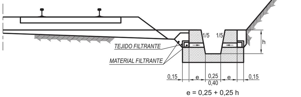
**ZANJA CON ELEMENTOS PREFABRICADOS**
