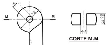
En el agujero de 6 mm irá eje de acero remachado con los extremos sin sobresalir de la superficie del mandril
