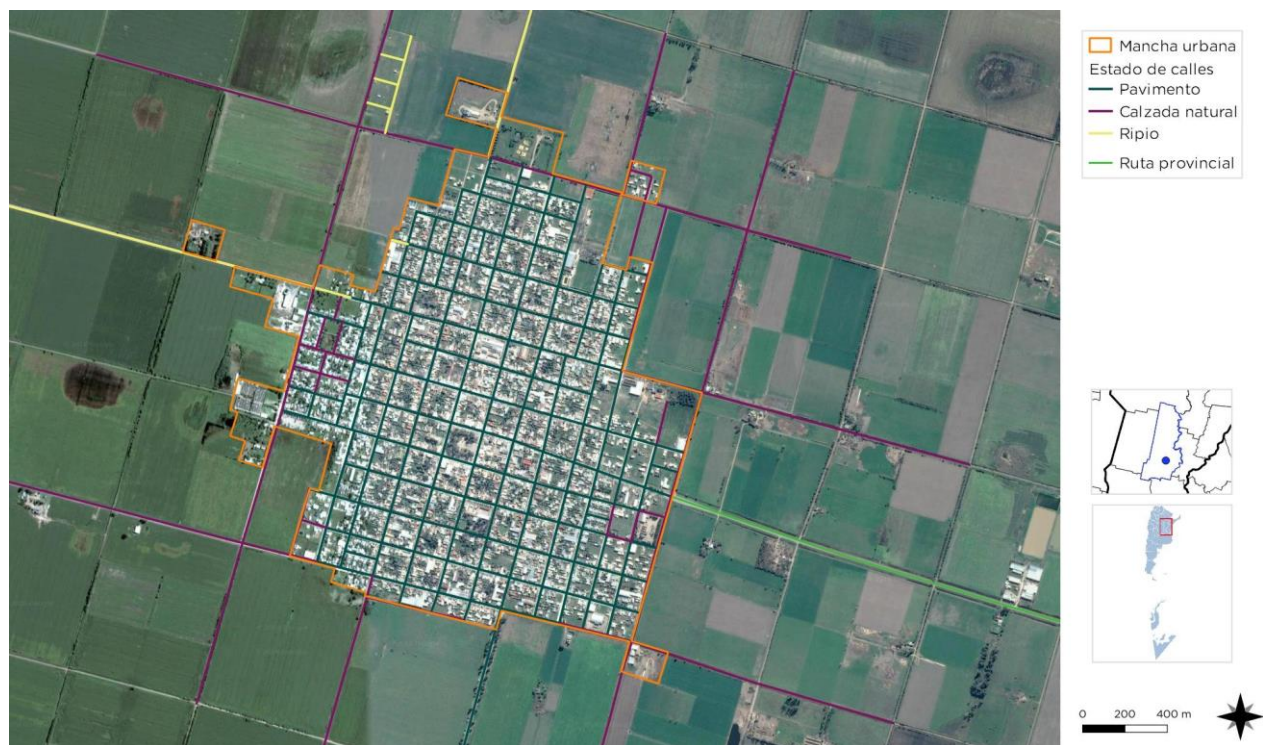
Calles pavimentadas de San Jerónimo del Norte – Fuente Secretaría de Planificación Territorial y Coordinación de la Obra Pública
