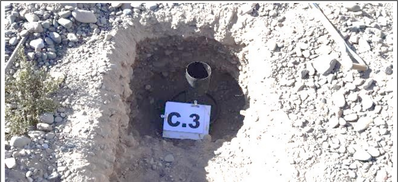
Fotografía N°19: Calicata C.3 , se observa el ensayo de densidad in situ por el método del cono y la arena (Norma DNV) a la Prof. de 1,00m en el estrato subyacente de grava arenosas.
