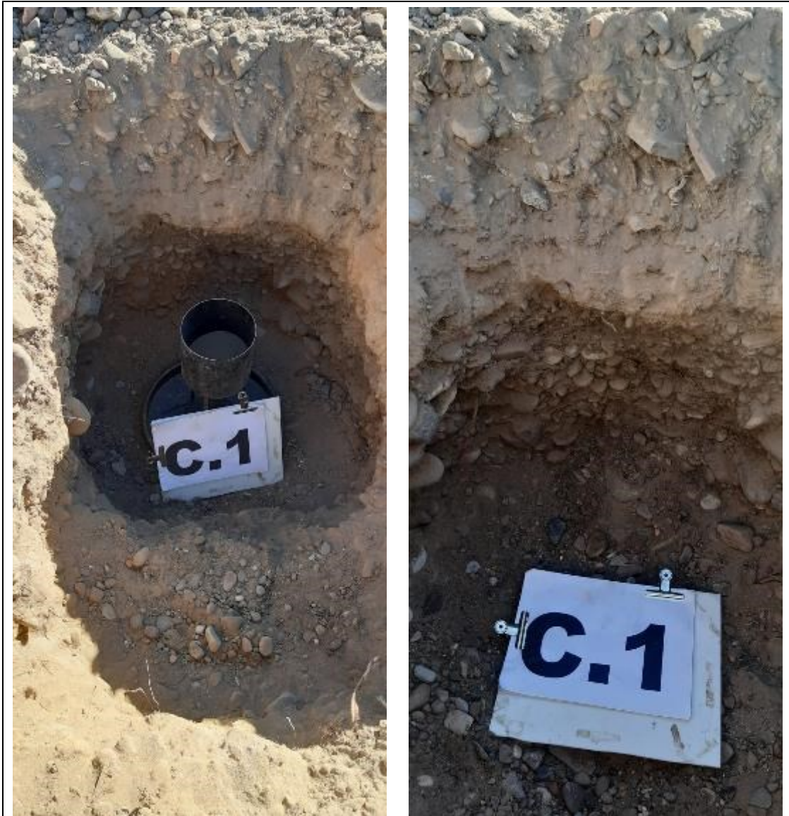
Fotografía N°9 y 10: Se muestra la excavación de la calicata C.1 , observando el perfil estratigráfico de suelos compuesto formado por un relleno superior de 0,30m, le continúa el estrato de suelo natural granular grueso formado por gravas arenosas. Se observa el ensayo de densidad in situ por el método del cono y la arena (Norma DNV) a la Prof. de 1,00m en el estrato subyacente de grava arenosas.
