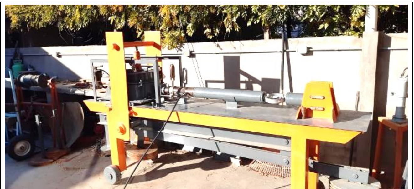
Fotografía N°20: Se observa el dispositivo de corte armado para suelos granulares, con caja de corte de diámetro 36cm.
