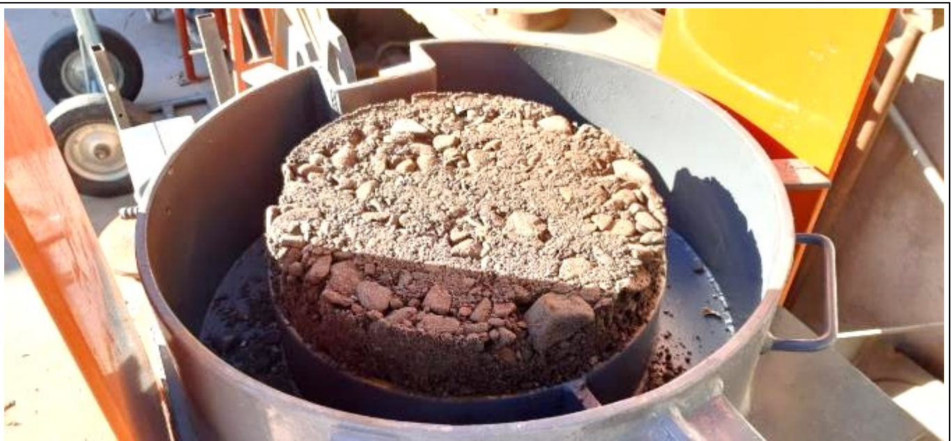
Fotografía N°22: Se observa el dispositivo de corte armado para suelos granulares, con caja de corte de diámetro 36cm. Se muestra la probeta ensayada.
