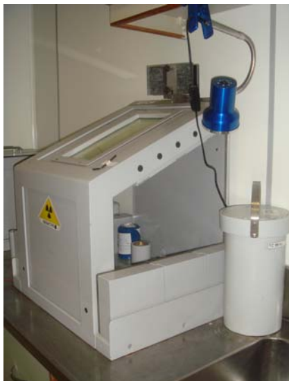
Figura 2. Pantalla de Fraccionamiento de plomo para Servicios de medicina nuclear PET
