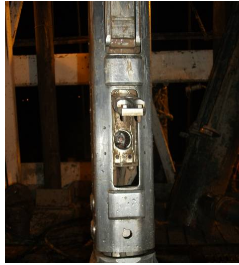
Figura 8. Preparación de la herramienta de perfilaje para recibir la fuente radiactiva. (Mossoró, Brasil)
