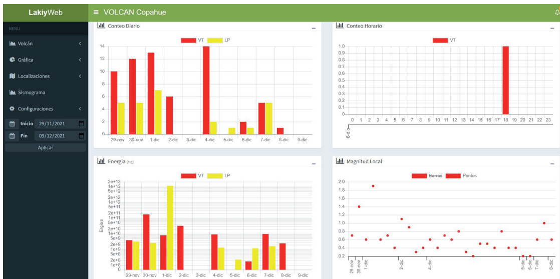
Sistema de detección, clasificación y localización automática de sismología (Laiky).
