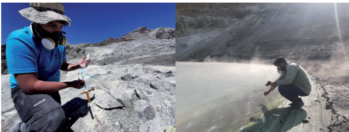
Fig 9: Izq: Muestreo de gases realizado en el cráter del Complejo Volcánico Planchón-Peteroa. Der: Toma de mediciones de temperatura y Ph en el cráter del volcán Copahue.
