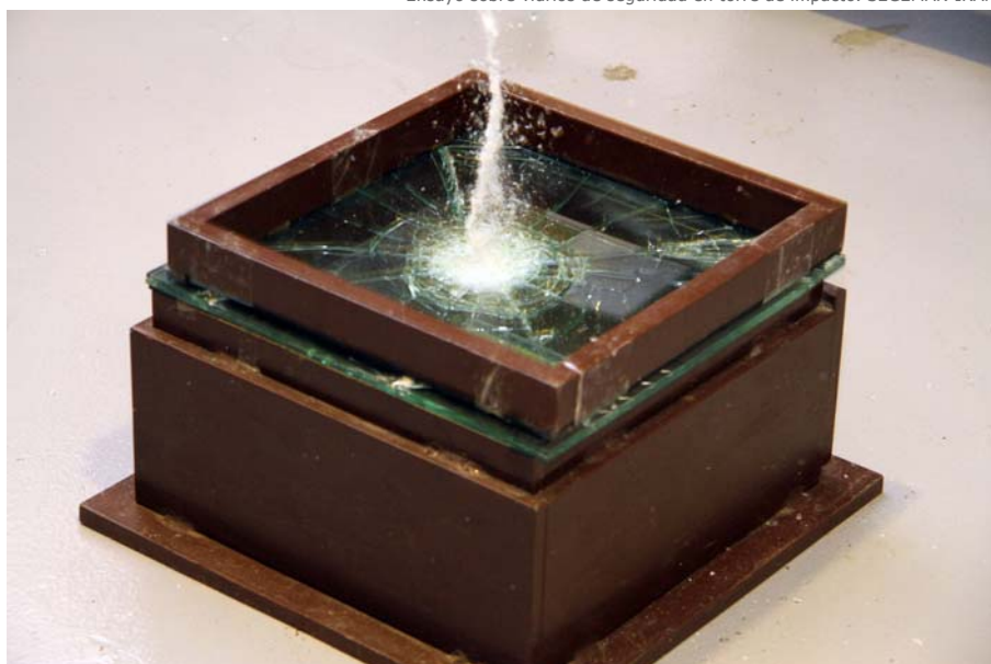
Ensayo sobre vidrios de seguridad en torre de impacto. SEGEMAR-IRAM
