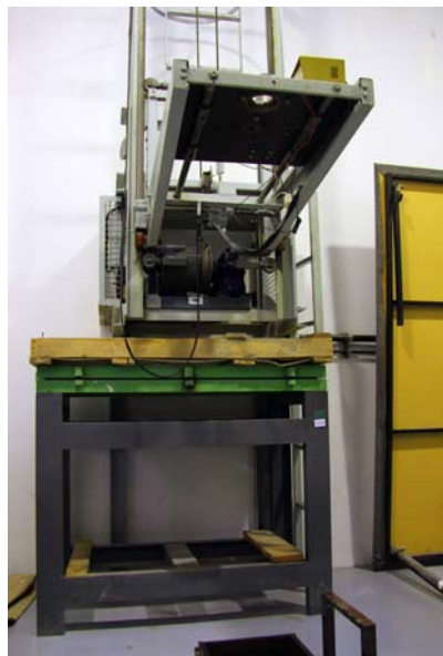
Ensayo en torre de impacto: rotura de vidrio
