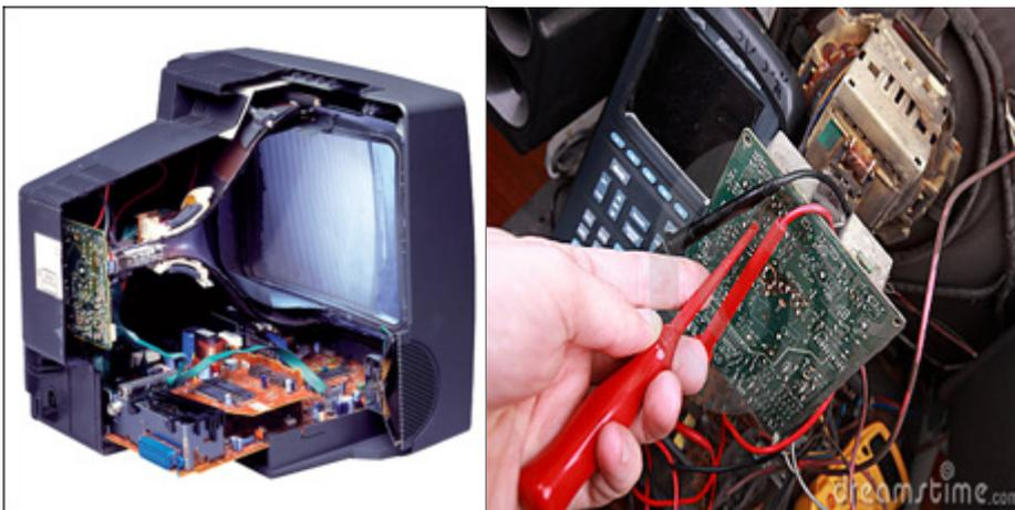
**Imagen 24. Las reparaciones o reacondicionamientos de tubos de rayos catódicos, cinescopio, plasmas o telas de LCD/LED implica trabajar con altos voltajes y riesgo de liberación de material fluorescentes potencialmente contaminado con gases como el trifluoruro de carbono (NF<sub>3</sub>) es 17.000 veces más poderoso que el dióxido de carbono (CO<sub>2</sub>), uno de los principales agentes de contaminación mercurio o cadmio.**
