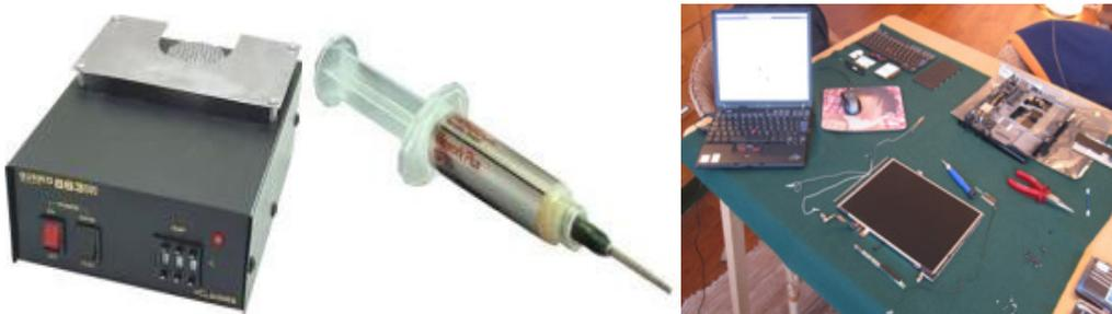
Imagen 26. Vista de equipos soladores, des-soldadores, calentadores para trabajar y reparar contactos, plaquetas y otras piezas de los RAEE.
