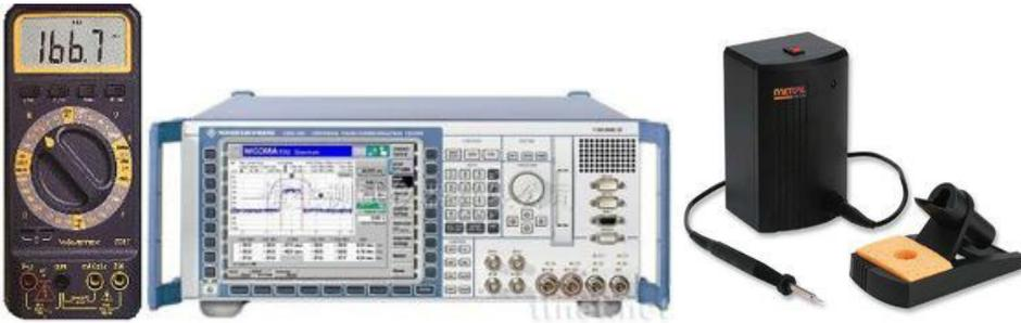
**Tester de señales de dispositivo:** El uso de diversos tester de aparatos o dispositivos electrónicos le permite la re-acondicionador obtener información acerca de la potencia de recepción y transmisión en las bandas que trabaja el terminal. Adjuntando luego de finalizada la reparación un test impreso con las diferentes pruebas que se realizaron en cada categoría de equipos.
