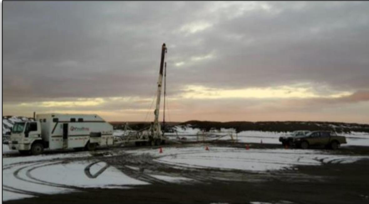
**Fig. 4:** Equipo de Slick Line utilizado para bajar registradores de presión dentro del pozo
