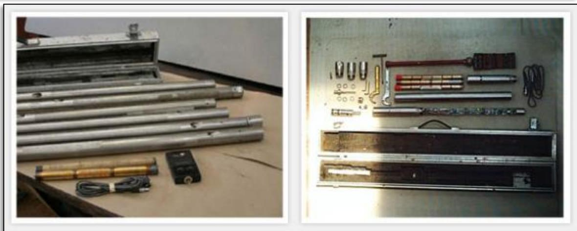
**Fig. 5 y 6:** Imágenes de un camión de alambre (slick) y de los registradores de presión y temperatura de fondo que son introducidos dentro de los pozos para realizar los diferentes tipos de estudios.
