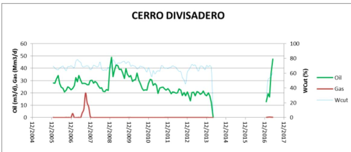
**Fig. 32:** Gráfico de producción en función del tiempo (en base a inf. del CIV).
