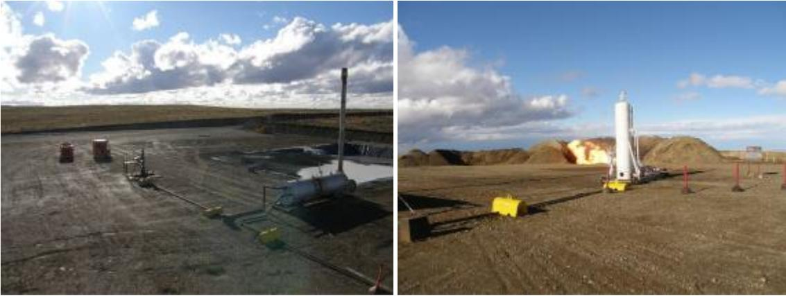
**Fig. 9 y 10:** Fotografías de un ensayo prolongado de producción de un pozo gasífero, en donde se puede ver la boca de pozo conectada a un separador vertical y la salida a una antorcha de quema.
