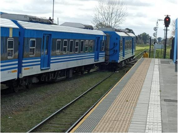
Reseña del suceso: el 3 de septiembre de 2020 el tren número 4059, un coche motor diésel eléctrico DMU (Diésel Motor Unit), de procedencia estación Dr. Antonio Sáenz, descarriló al atravesar el cambio de entrada (ADV) de la estación terminal Marinos del Crucero Gral. Belgrano. Siendo este tramo del ramal desde la estación Libertad hasta
