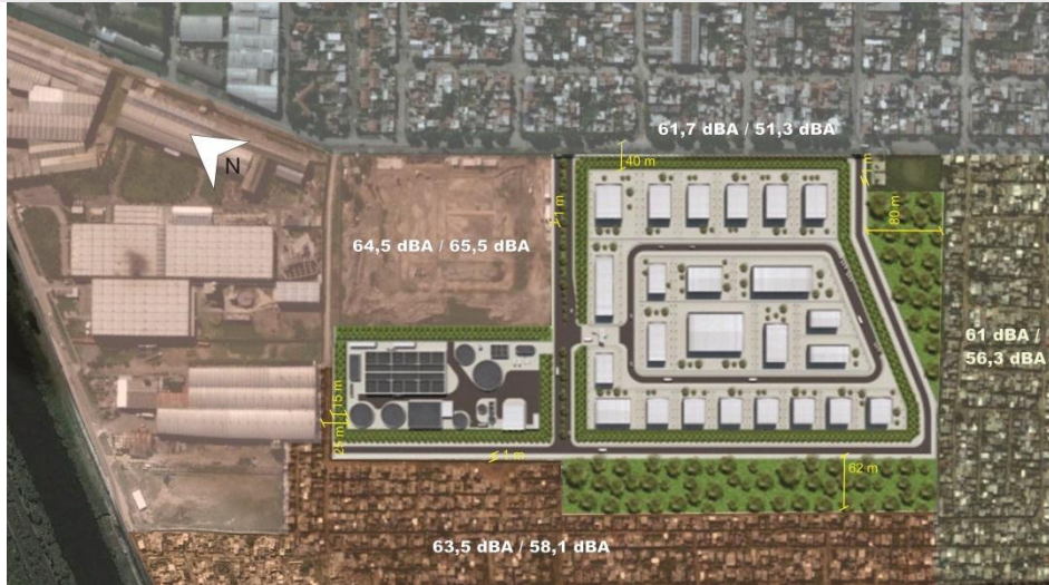
Figura 31. Distancias mínimas consideradas para el análisis durante la construcción del PIC. El nivel de ruido de fondo definido para cada sector esta expresado como Diurno / Descanso. FUENTE: UTN, 2014.
