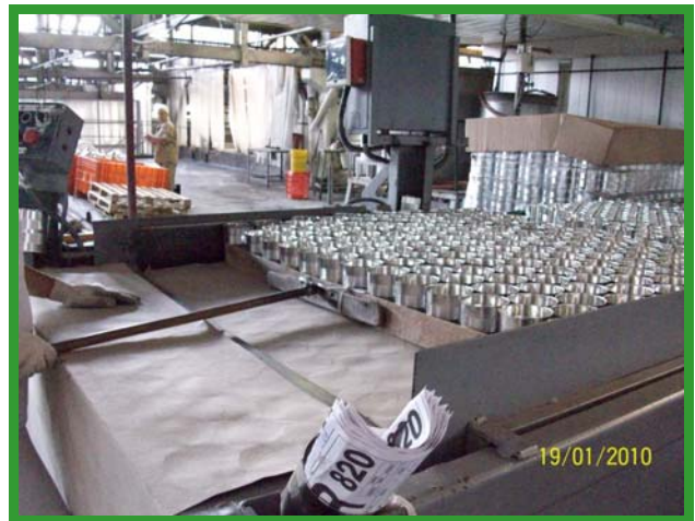
Foto 28: Colocación Mecánica de Latas a la Línea
