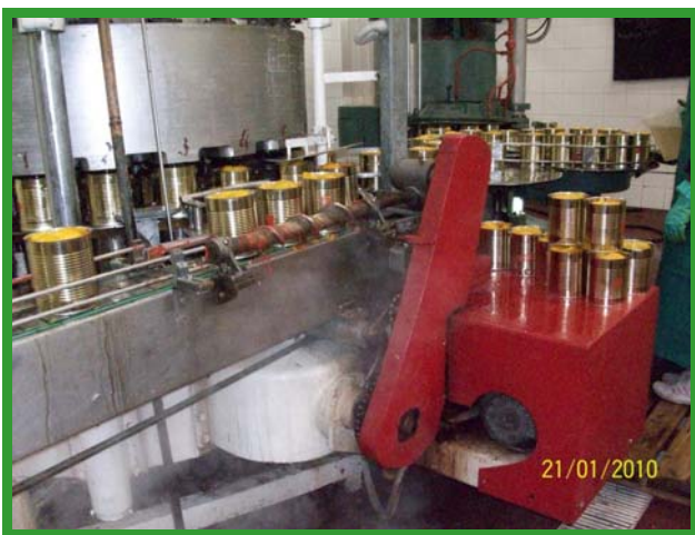
Foto 33: Línea de Prevacío
