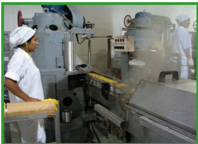
Foto 1: Egreso de Expulsor e Ingreso a Remachadora
