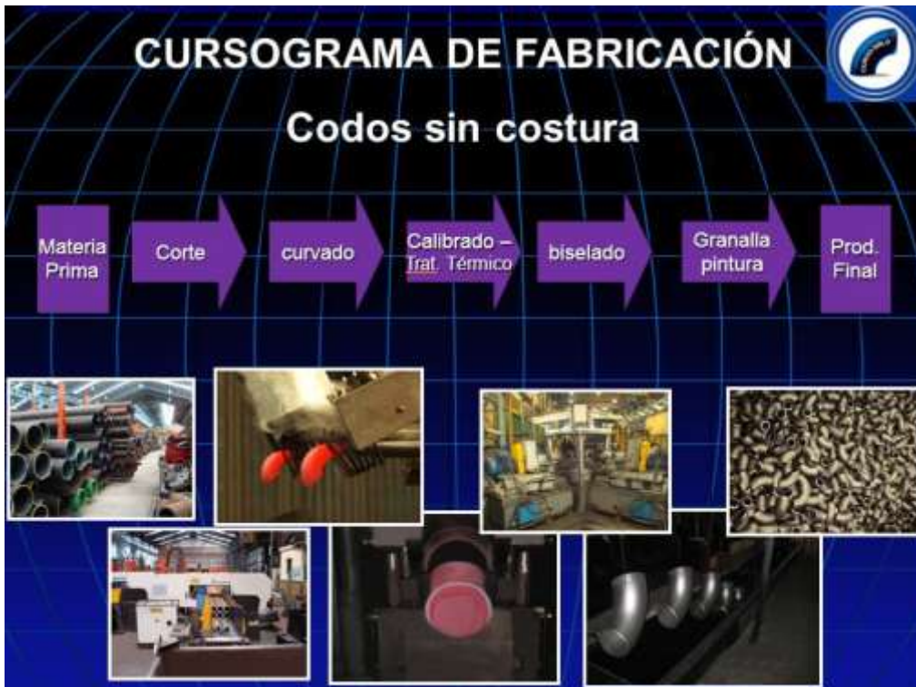
Imagen IV.3. Proceso de producción de codos en caliente
