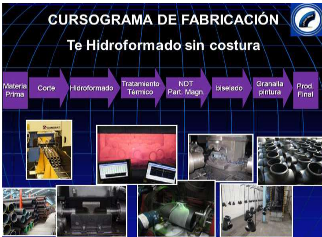
Imagen IV.2. Proceso de producción de Tes en frío
