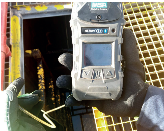
Medición de gases en Espacio Confinado
