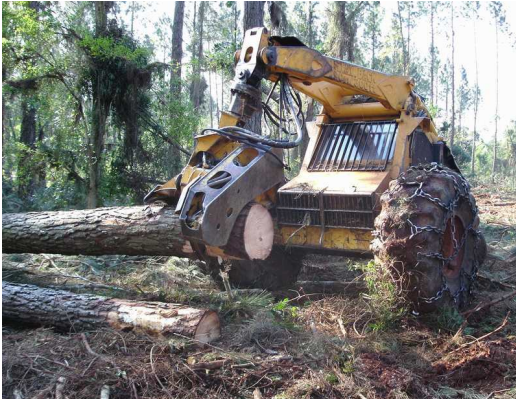
Fotos N° 28 y N° 29 Trineumático con sistema de garras con sierra a cadena
