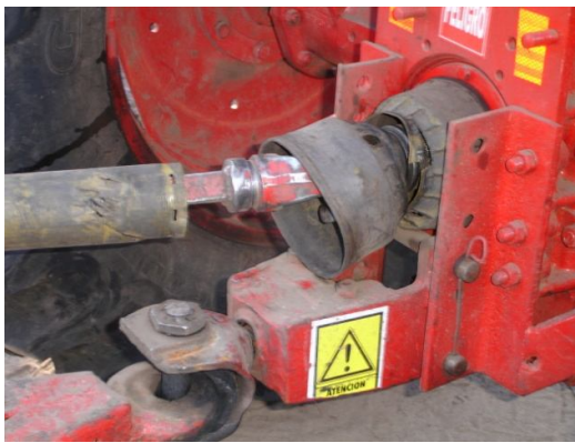
Foto N° 42 Toma de fuerza sin protección
