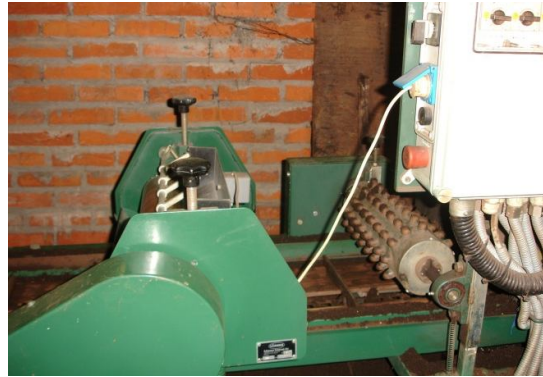
Foto N° 6 Máquina de siembra automática
