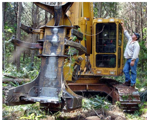
Foto N° 27 Sistema de garras y disco de corte
