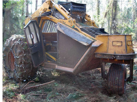
Fotos N° 28 y N° 29 Trineumático con sistema de garras con sierra a cadena
