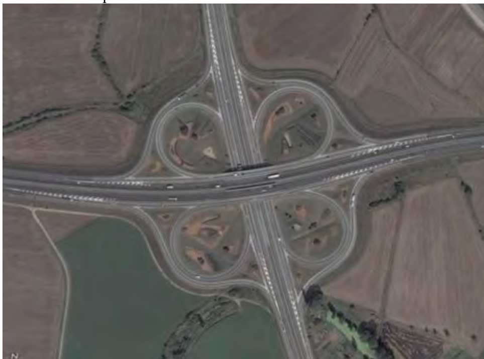
Figura: 26. Intersección tipo Trébol
