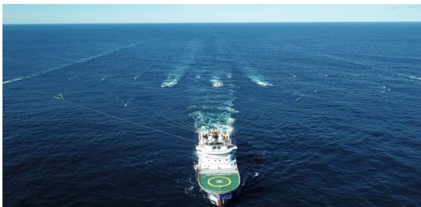
Figura 2. Fotografía de un buque sísmico, las fuentes de emisión y los cables sísmicos ( streamers ).
