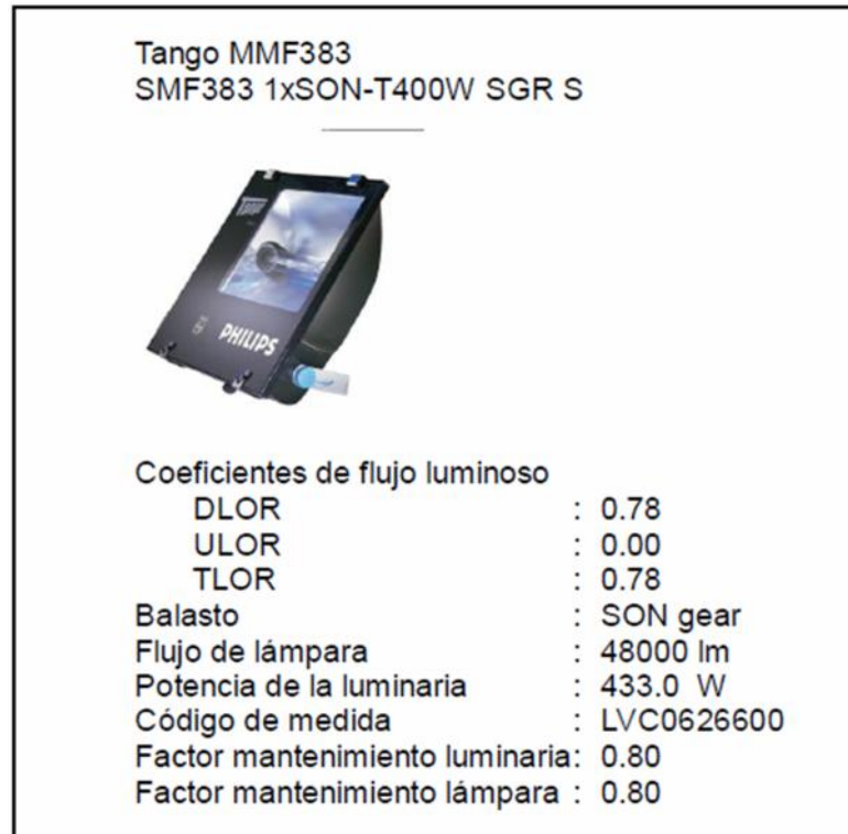
Imagen 9. Luminaria para torre de iluminación.
