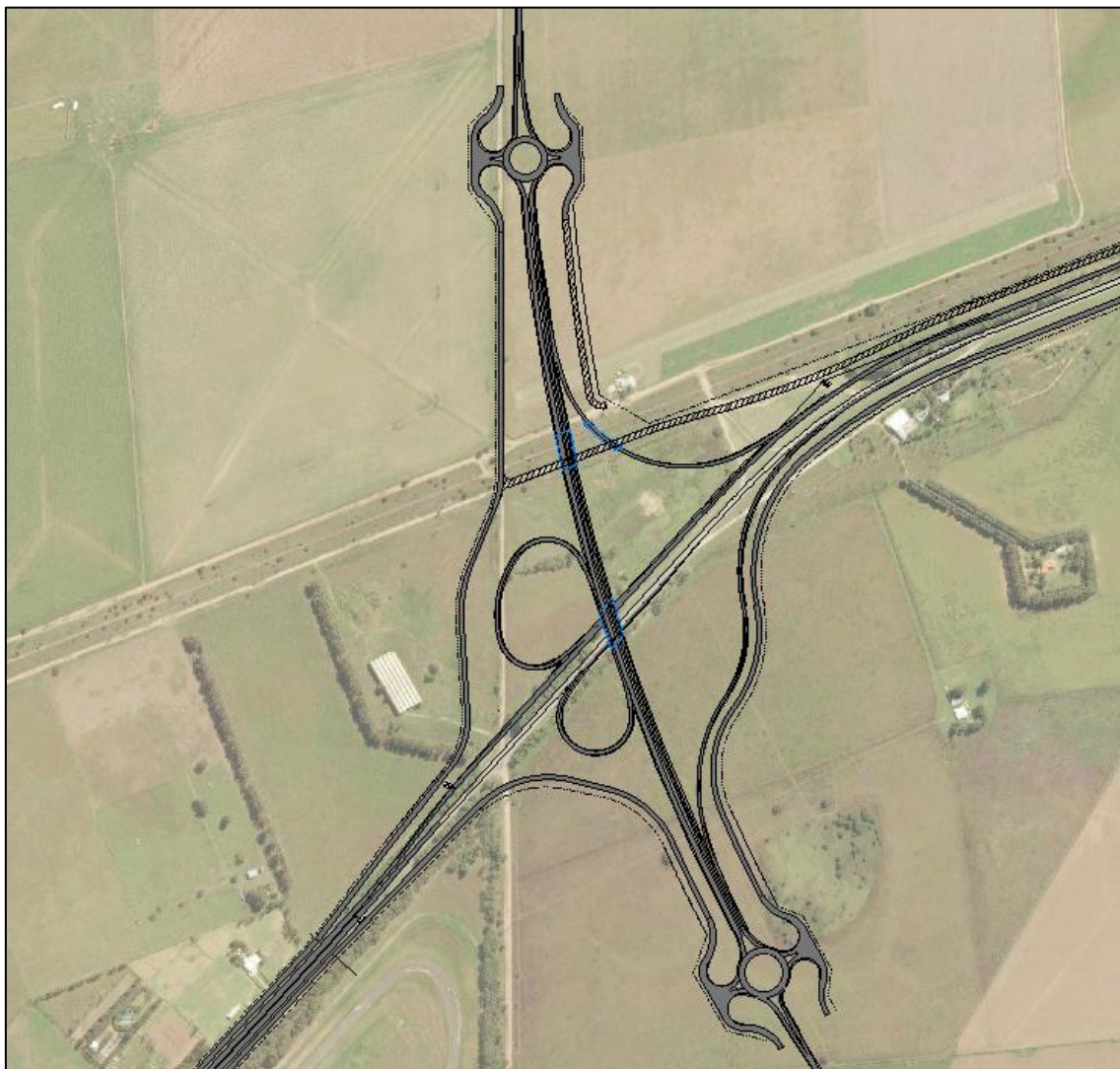
Figura N° 6: Distribuidor tipo trébol parcial en Intersección con Variante RN N°35
