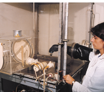
Cámara de referencia para la calibración de detectores de radón en el aire
