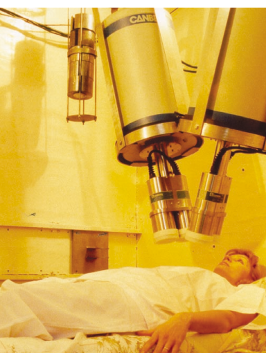
Contador de todo el cuerpo para mediciones específicas
