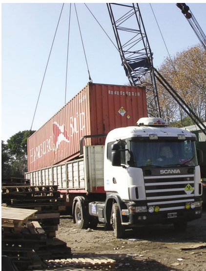
Acondicionamiento de material radiactivo en el vehículo de transporte
