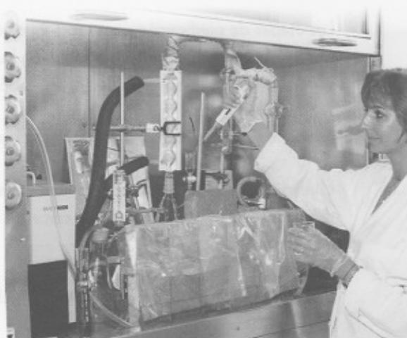
Con el propósito de alcanzar un grado de sensibilidad adecuado para la detección de yodo 129 en matrices ambientales, y teniendo en cuenta su baja actividad específica (6 Bq/mg) y además, la baja energía de emisión de fotones del yodo 129 ( $E = 29,78 \text{ keV}$ ), es necesaria la utilización de técnicas de activación neutrónica.
