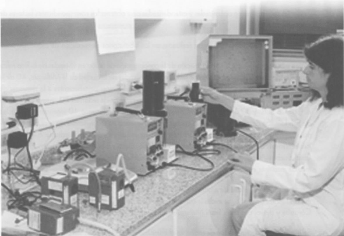
En el laboratorio se realiza la determinación de los descendientes del radón de período corto no adheridos a aerosoles. El principio del método se basa en la atracción electrostática por filtros de malla de alambre de los átomos libres.
