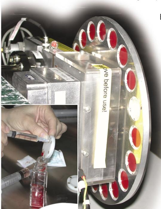
Irradiación de muestras de sangre con partículas alfa en acelerador de iones
