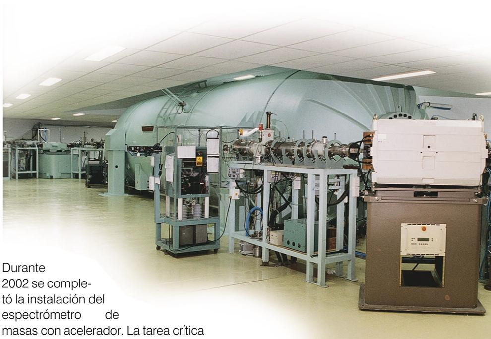
Durante 2002 se completó la instalación del espectrómetro de masas con acelerador. La tarea crítica y más importante fue la instalación de los tubos de aceleración. Si bien se trata de un trabajo para especialistas, las limitaciones presupuestarias exigieron que el mismo fuera llevado a cabo por personal de la institución.
