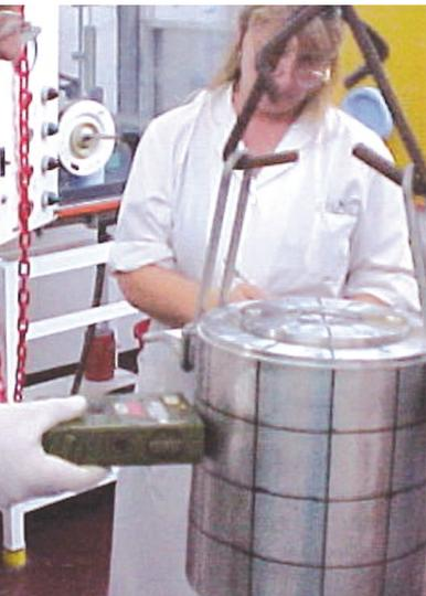
**Ensayo radiométrico a bulto antes de la primera expedición**
