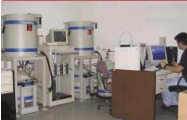
Sistema de medición de la estación monitora de radionucleidos RN01 Ciudad de Buenos Aires
