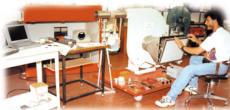
Banco de prueba de filtros
