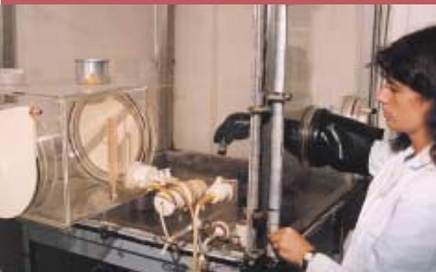
Cámara de referencia para la calibración de detectores de radón de aire.
