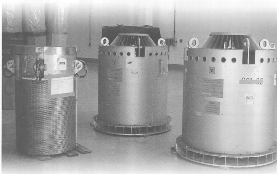
Bultos del tipo B(U) para transporte de cobalto 60. Modelos GURI 01 (centro y derecha) y F129 (izquierda)
