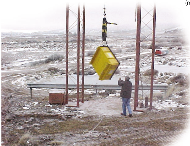
Ensayo mecánico para condiciones accidentales de transporte
