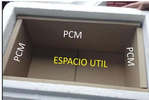
FIGURA 2. Armado de la conservadora con PCM XV-15 posibilita un volumen útil del 80% del volumen total de la conservadora.
