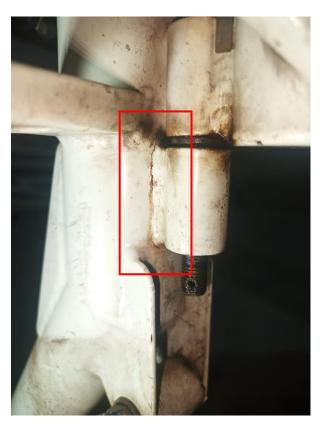
De los cuatro informes, cuatro indican que se detectó fisura en uno de los bujes de pata, y el cuarto, en uno de los bujes de bancada.
