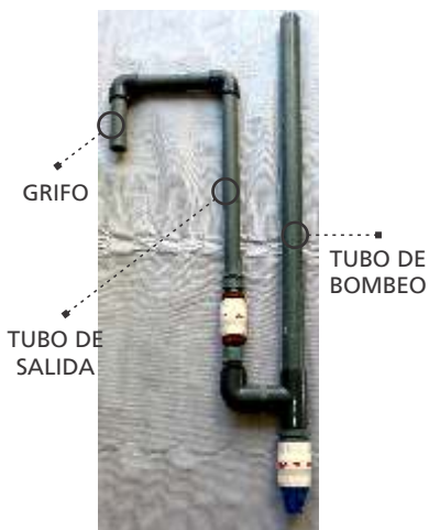
Imagen 3: Sistema de Válvulas y Tubos
