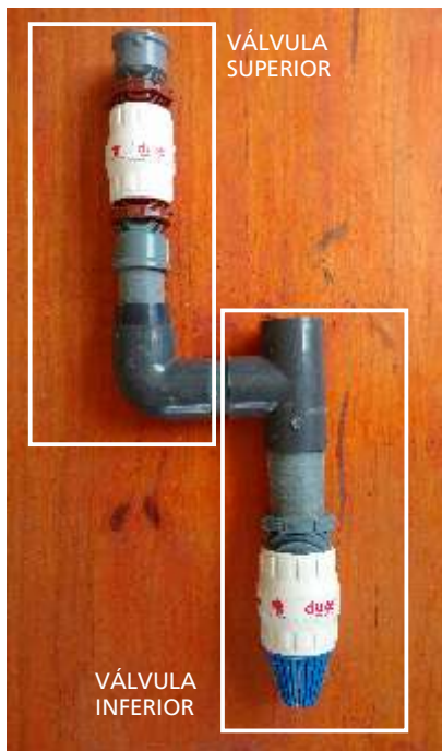
Imagen 2: Sistemas de Válvulas Terminado
