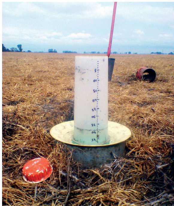
Fotografía 1. Infiltrómetro de anillo simple con disco soporte y botella graduada.
