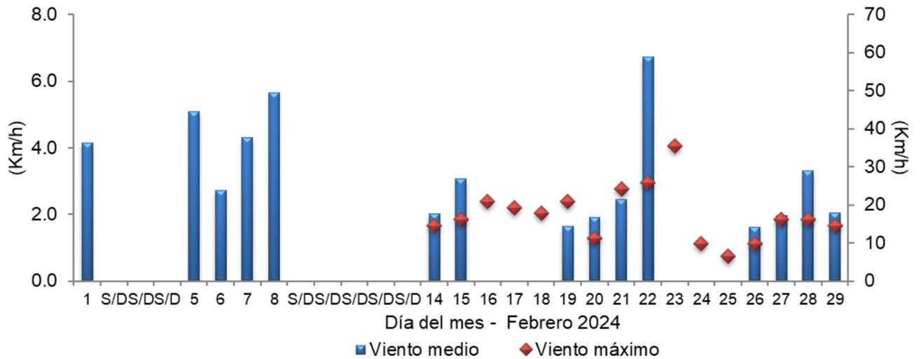
Figura 11. Valores de viento promedio diario a partir de anemómetro y, valor del viento máximo diario registrado por estación meteorológica automática.
