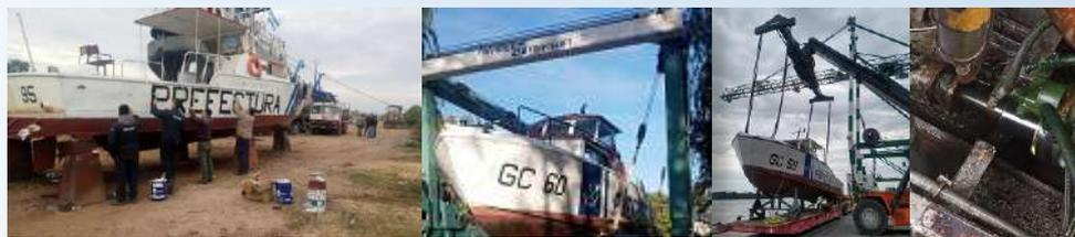
En proceso de finalización de trabajos de carenado, recorrido de líneas de ejes y recorrido de motores principales al Guardacostas Tipo 48 PNA “EL CHALTEN GC-88” (GUAZ).
