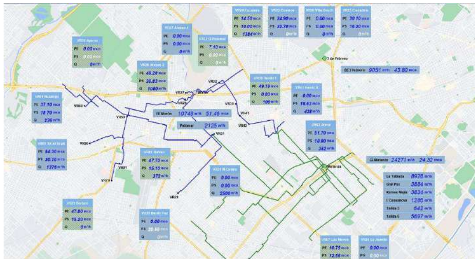
Esquema Sistema Morón y Matanza: acueductos principales y válvulas reguladoras
