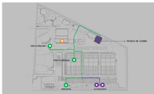
Puntos de dosificación de cloro
