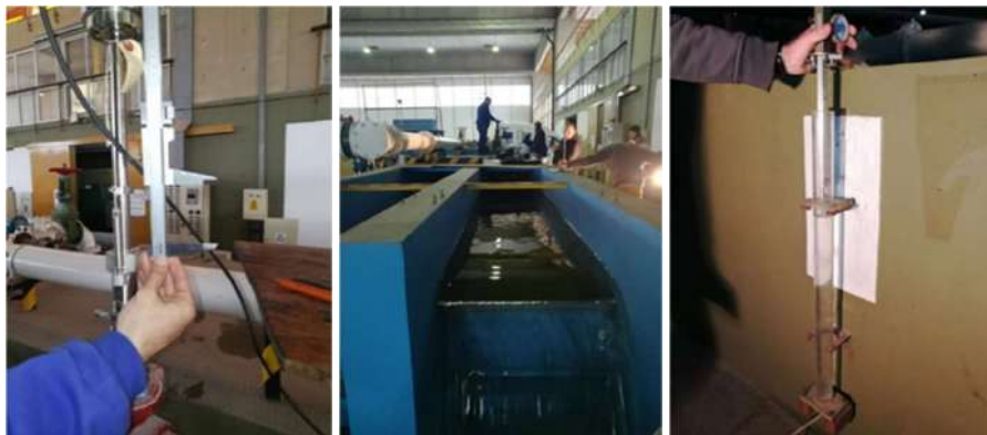
Calibración de caudalímetros de inserción en el INA
