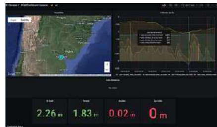
Herramienta para la visualizacion y control remoto de la Red de Monitoreo
