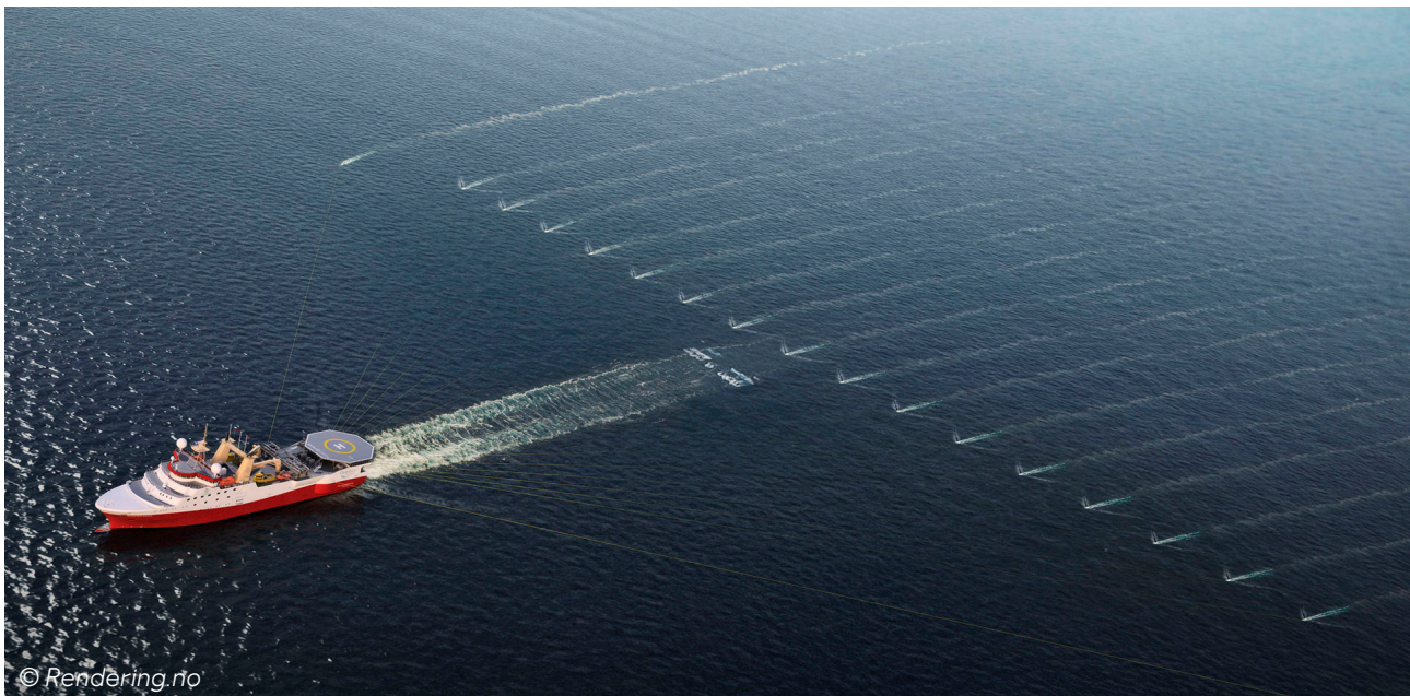
Figura 3: Ejemplo de un buque sísmico como el que se utilizará para llevar a cabo el relevamiento sísmico 3D.
