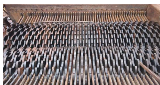
FG84: Proceso de recolección de RAC. Trituración
