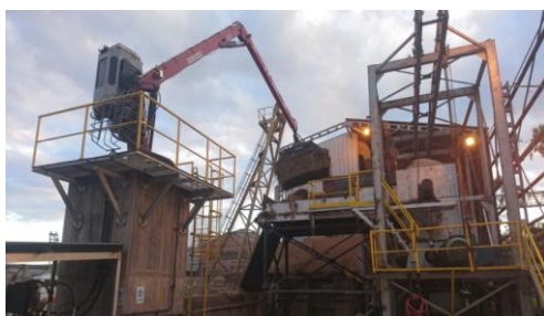
FG84: Proceso de recolección de RAC. Trituración
