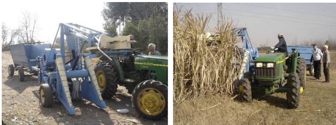
FG52: Cosechadora de caña entera sin proceso de quema previo
