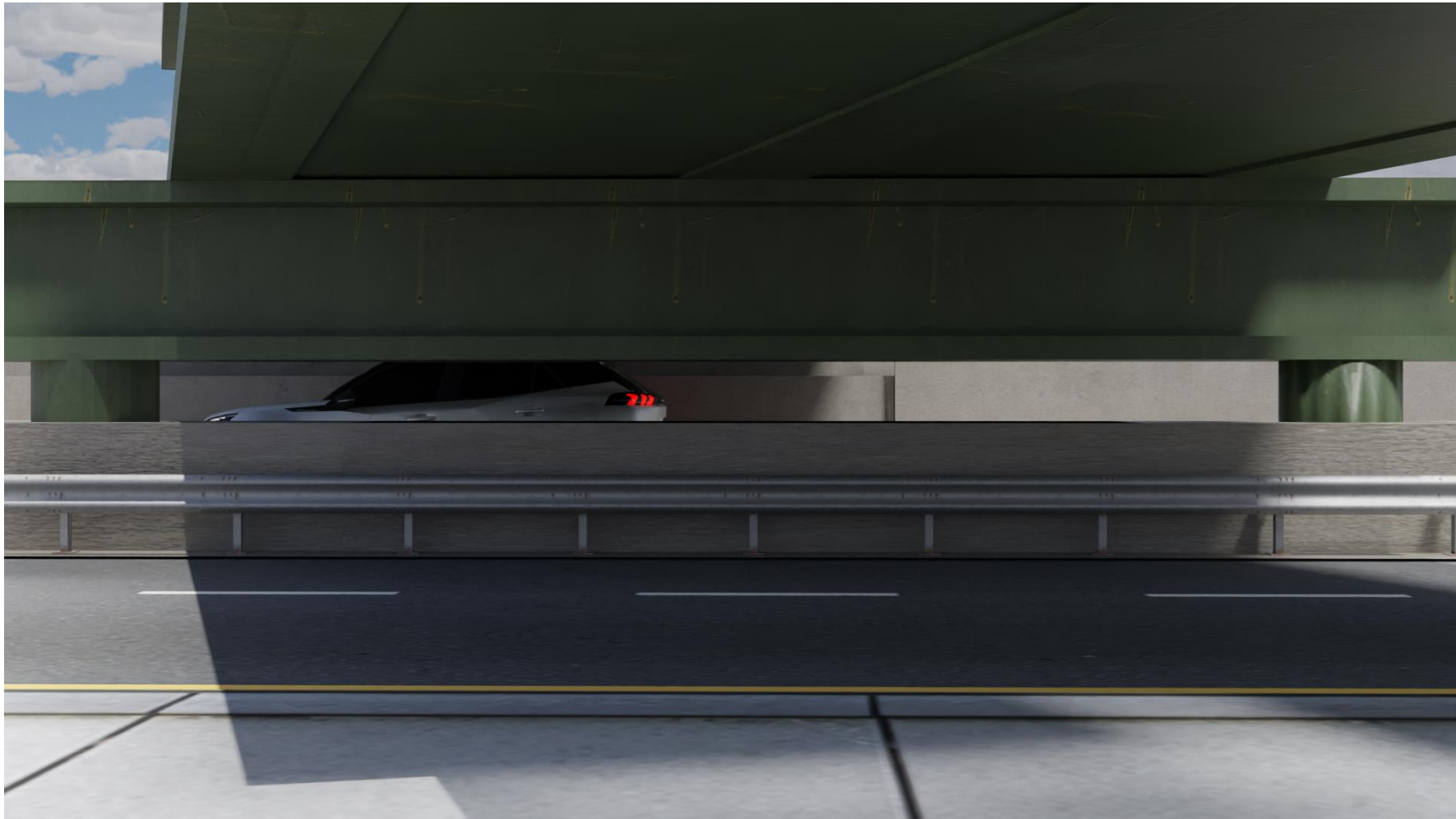
Figura 3 Dintel con 2 pilares. Fuente: JST
