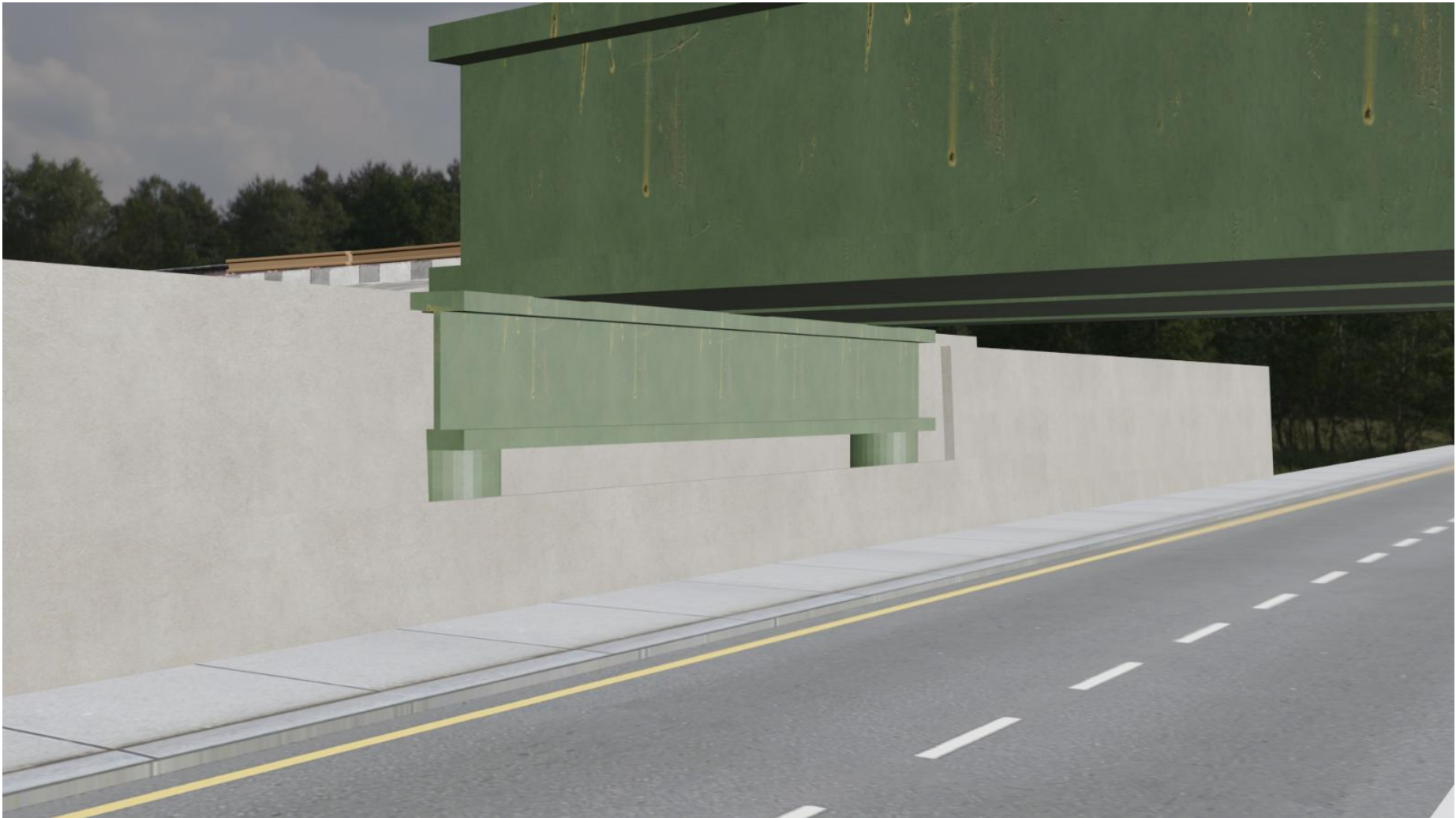
Figura 1. Dintel con 2 pilares. Fuente: JST
