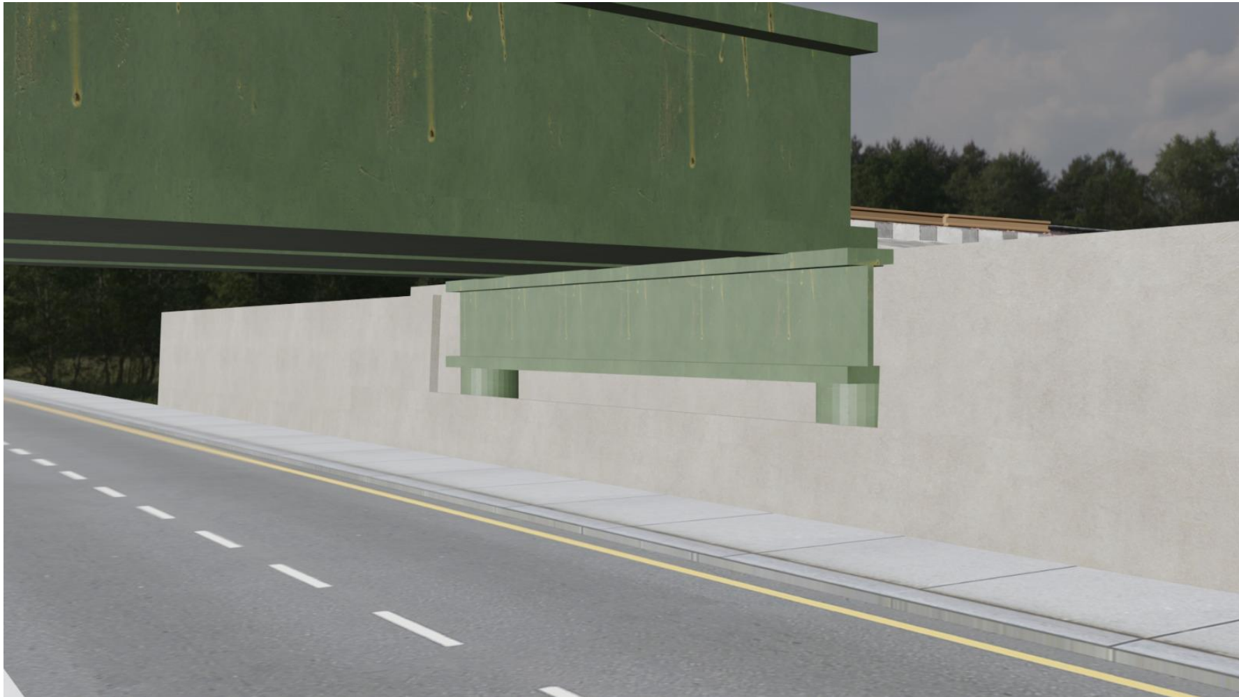
Figura 5 Dintel con 2 pilares. Fuente: JST
