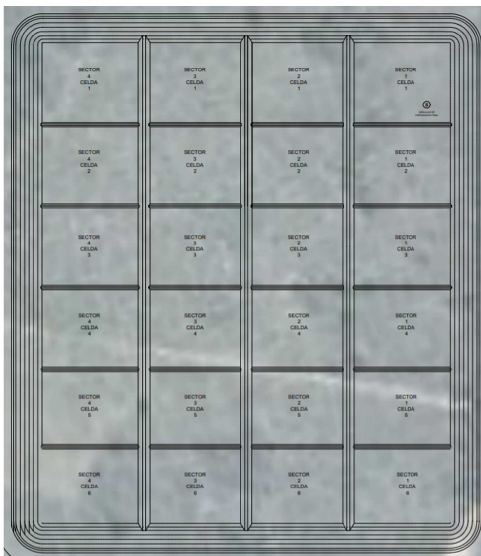
Centro Ambiental Santiago del Estero - Módulos de Disposición Final. Elaboración propia.
