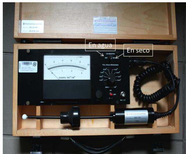
Figura 3. Radiómetro Biospherical QSL-100
