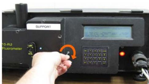
Figura 9. Vista general del fluorómetro Turner Designs 10-AU en el que se indica la dirección de giro para ajustar el tornillo de ajuste de bloqueo de la sensibilidad.
