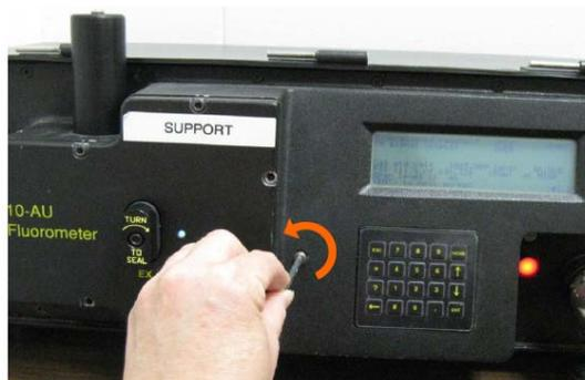
Figura 6. Vista general del fluorómetro Turner Designs 10-AU en el que se indica la posición y dirección de giro para desajustar el tornillo de bloqueo de la sensibilidad.
