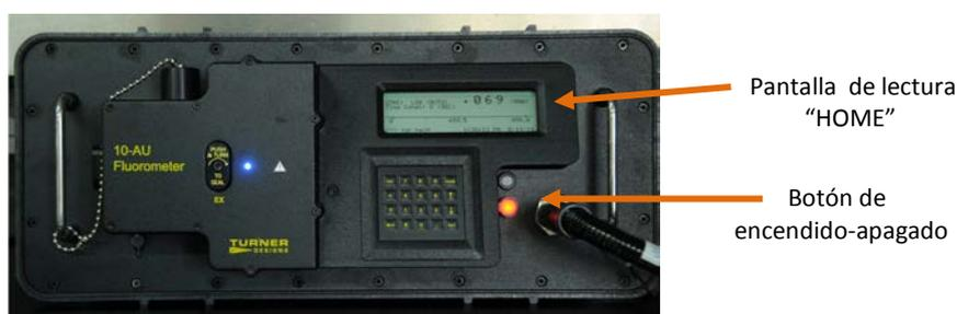
Figura 1. Vista general del fluorómetro Turner Designs 10-AU.
