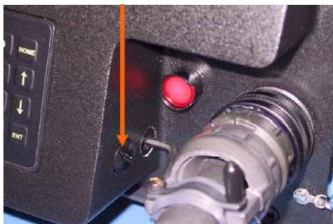
Figura 7. Detalle del fluorómetro Turner Designs 10-AU en el que se indica la posición de la perilla de ajuste de sensibilidad.
