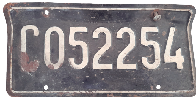
Deterioros observados en las patentes: suciedad superficial, depósitos de barro, óxido rojizo, faltantes, deformación de plano, desprendimiento de pintura, rayaduras.
