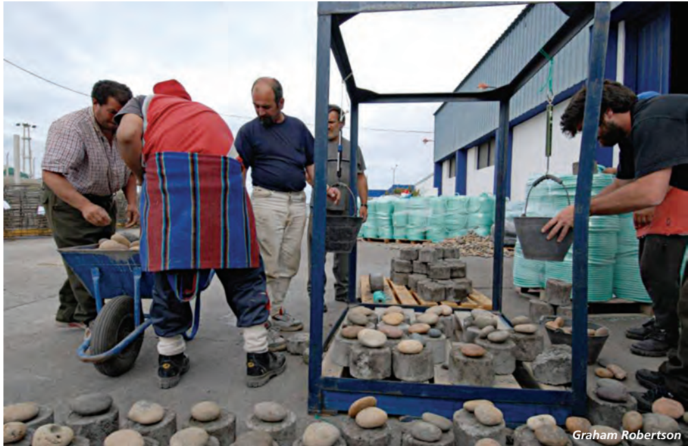
Figura 4. Preparado experimental de lastres de material y piedras envueltas en red.
