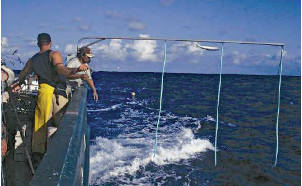
Figura 12. Cortina de agua desplegada por la banda para su uso en el virado del palangre.
