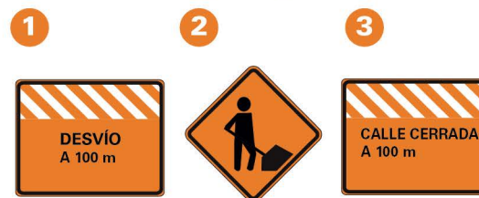
Emplazamiento sobre poste Cartelería de señalamiento transitorio Reflectiva grado ingeniería
