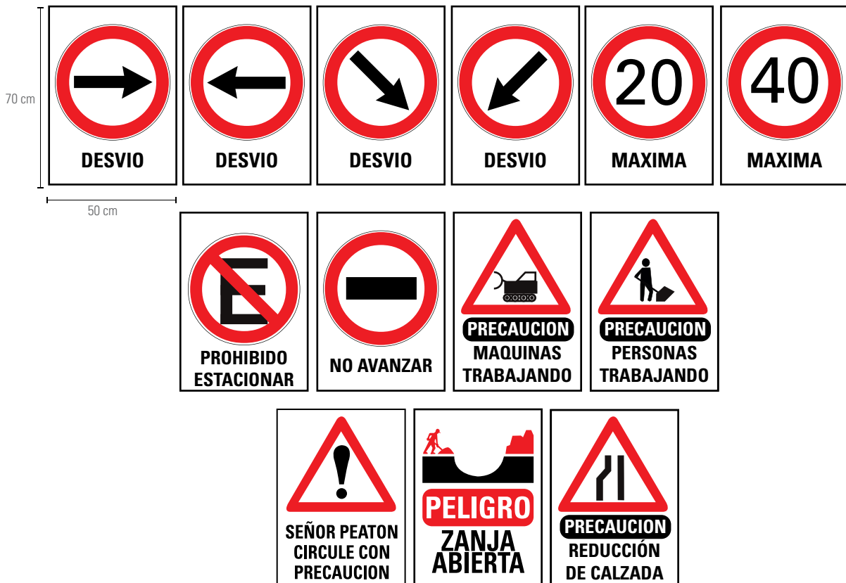
Emplazamiento sobre vallado Cartelería de señalamiento vertical
