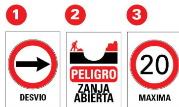
Emplazamiento sobre vallado Cartelería de señalamiento vertical
