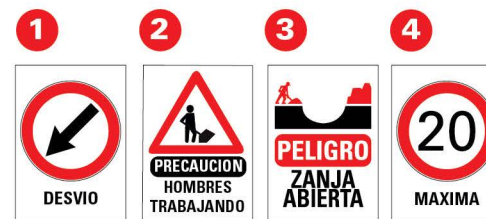
Emplazamiento sobre vallado Cartelería de señalamiento vertical
