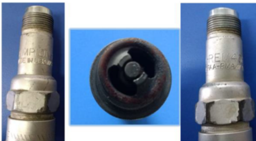
Figura 5. Imágenes de una de las bujías que mostró falla.
